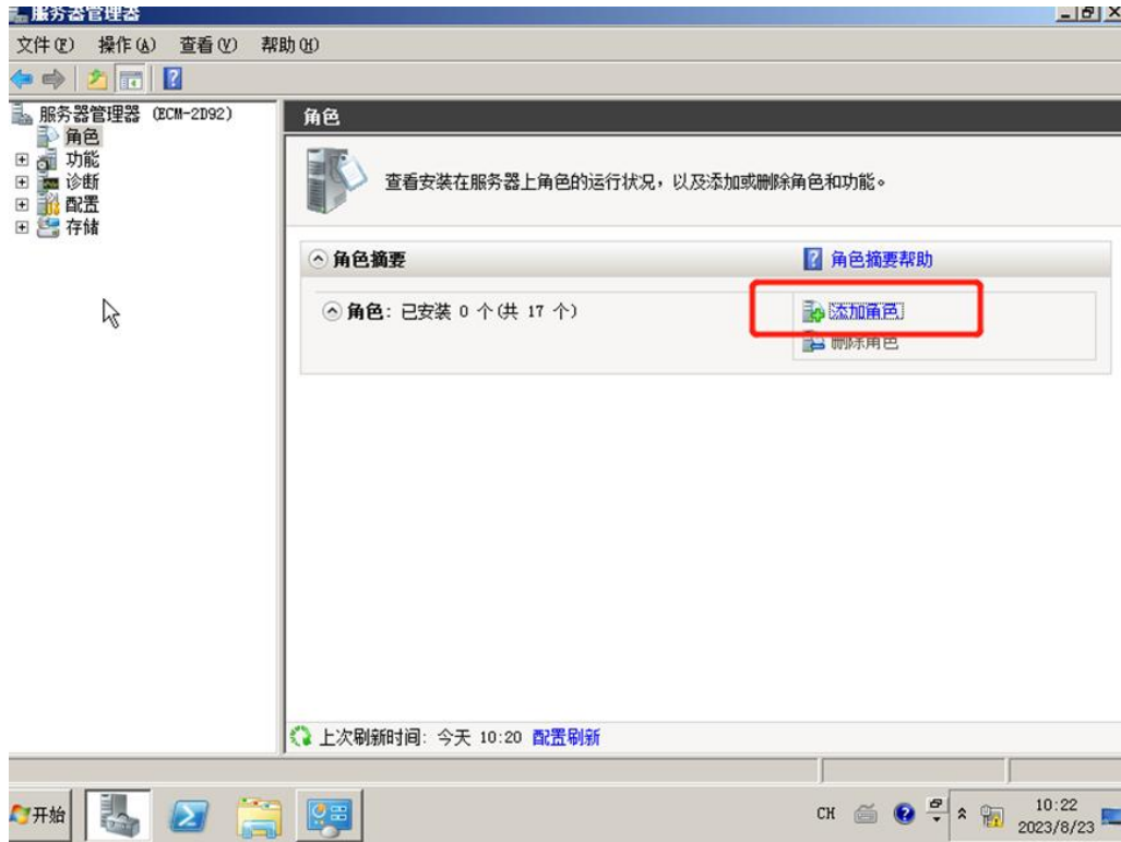
图 3 开启 IIS 信息管理服务器搭建 FTP 站点步骤 2
