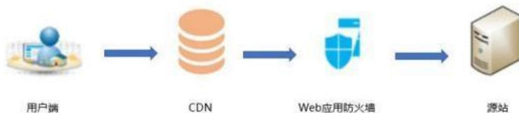
用户请求先到CDN, 由CDN将请求转发到Web应用防火墙, Web应用防火墙再将请求转到源站服务器。
