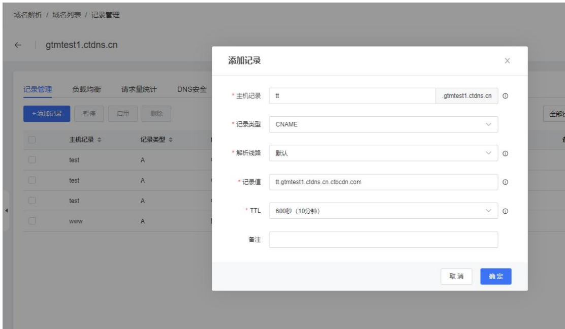
图 5-13 主机记录 CNAME 到 GTM 接入域名配置-1
