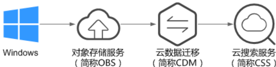
图4-7 使用 CDM 从 OBS 导入数据到 Elasticsearch 时的数据传输流程
