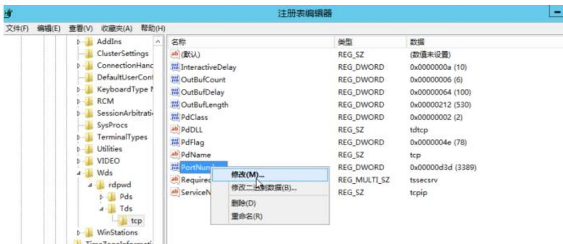
8. 在弹出的修改窗口中, 在数值数据的文本框中输入新的远程端口号, 以 3398 为例。在基数框中勾选十进制, 然后单击“确定”。
